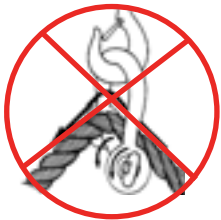
Figure 3.20 Déplacement de l'élingue sur le manillon
